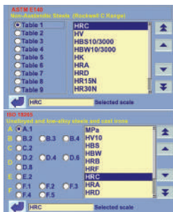
Conversioni nelle varie scale di durezza secondo le norme ISO e ASTM.
