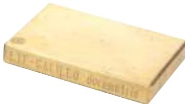
**CSP10** Scale di durezza Vickers: HV0,05; HV0,1; HV0,2;
