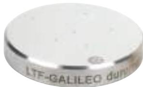
**CSP4** Scale di durezza Brinell
